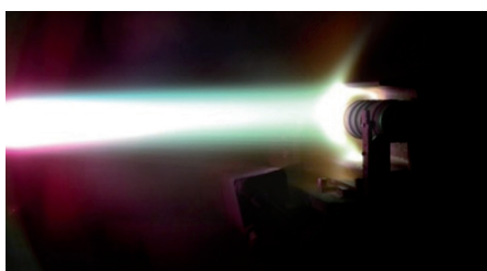
Abb. 3: Plasmakammer der Hochenthalpie Plasmabeschichtung (Bild: 4th Condition)
